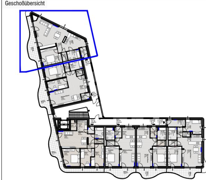
Alle offenbaren Fenster sind Drehkippenfenster, restliche Fenster sind fixverglast. Dargestellte Einrichtungsgegenstände sind unverbindliche Vorschläge, zulässige Bautoleranzen sind möglich, Planmaße sind Rohbaumaße.
